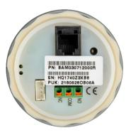
Le veKonvert détecte automatiquement l'appareil Victron auquel il est connecté et ajuste les données NMEA 2000 qu'il émet en conséquence.
